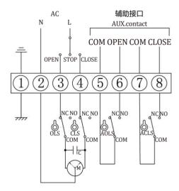
② - ③: 开阀控制(2接N) ② - ④: 关阀控制(2接N) ⑤ - ⑥:全开无源触点反馈 ⑦ - ⑧:全关无源触点反馈 ⑤ - ⑦: 为公共端,可以短接
