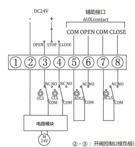
② - ④: 关阀控制(2接负极) ⑤ - ⑥:全开无源触点反馈 ⑦ - ⑧: 全关无源触点反馈 ⑤ - ⑦ : 为公共端,可以短接
