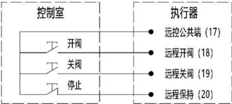
方案3：保持模式开阀/关阀，执行器可以停在中间任意位置。
